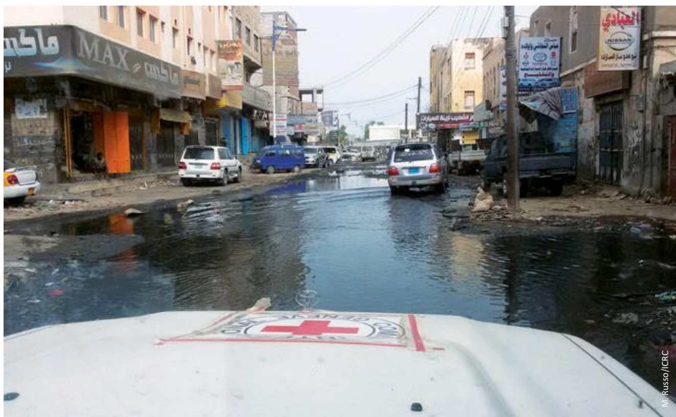
Фотография 6. Необходимо понимать взаимосвязанность основных служб жизнеобеспечения и должным образом учитывать ее в мерах реагирования на чрезвычайные ситуации, чтобы избежать контрпродуктивных последствий. Модернизация вышедшей из строя сети водоснабжения в этом квартале без устранения неисправности системы отвода сточных вод увеличила бы риски для здоровья населения, вызвав попадание сточных вод на улицы (г. Аден, Йемен, 2015 г.)
